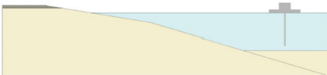
Figuur 4. Natte winning in scheren, parallel aan de ingerichte taluds.
